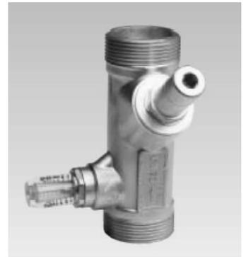
Настройка производится с помощью косо врезанного вентиля с большим передаточным числом шпинделя. Монтаж в любом положении на падающем или обратном трубопроводе. Условный проход Ду 15...50 мм. Максимальная температура 100° С при максимальном рабочем давлении 10 бар, 120°С при 6 бар. Для моделей Ду 25...50 мм предусмотрена функция Мето stop, обеспечивающая фиксацию установки вентиля посредством двойного шпинделя.
