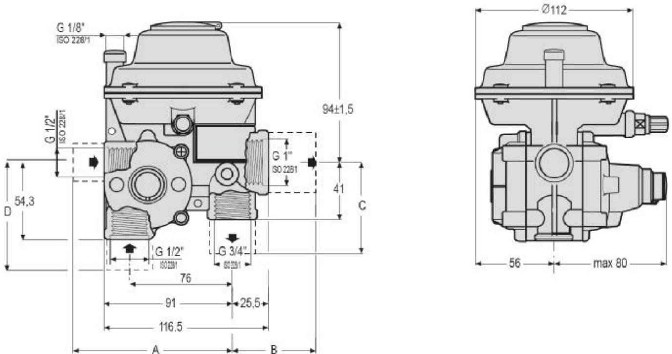
Для FE S с накидными гайками на входе 3/4" и выходе 1 1/4": A = 106; C = 60.
