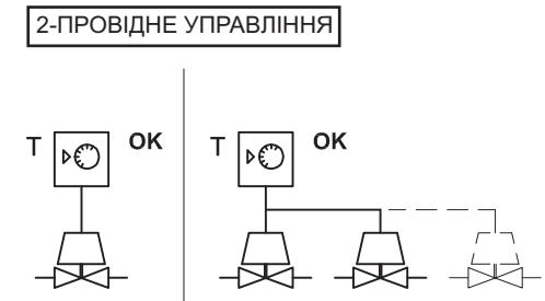
СЕРВОМОТОРИ З 2-ПРОВІДНИМ УПРАВЛІННЯМ МОЖУТЬ БУТИ ПАРАЛЕЛЬНО ПІД'ЄДНАНІ ДО ОДНОГО ТЕРМОСТАТУ АБО УПРАВЛЯЮЧОГО БЛОКУ
