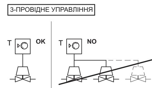
СЕРВОМОТОРИ З 3-ПРОВІДНИМ УПРАВЛІННЯМ НЕ МОЖУТЬ БУТИ ПАРАЛЕЛЬНО ПІД'ЄДНАНІ ДО ОДНОГО ТЕРМОСТАТУ АБО УПРАВЛЯЮЧОГО БЛОКУ
