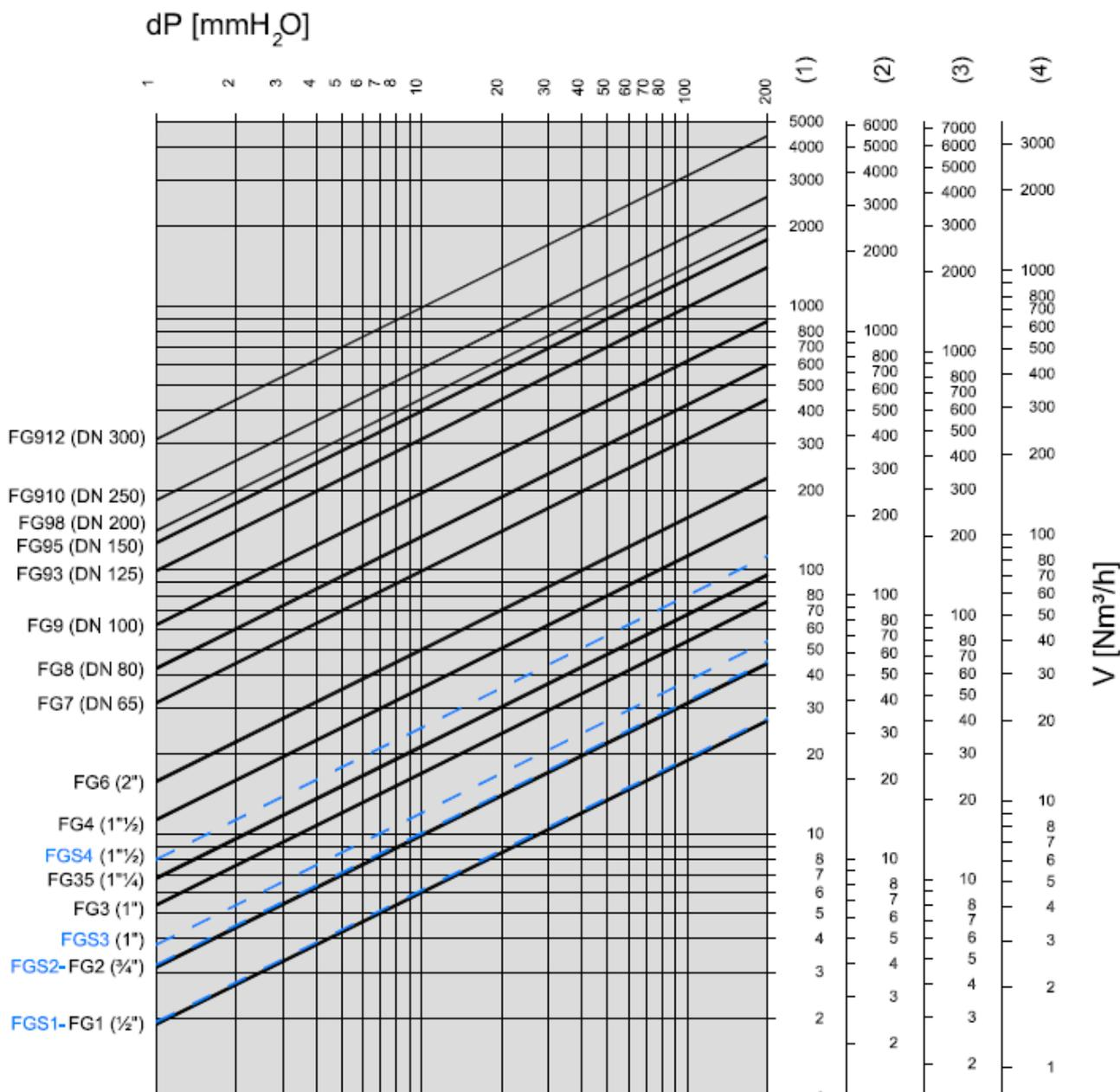
Обычно диаметр фильтра подбирают таким образом, чтобы перепад давления на нем не превышал 10 мбар, а скорость газа - 20 м/с.
