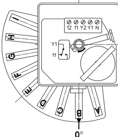
Для регулировки эксцентров I и II извлечь фиксатор
