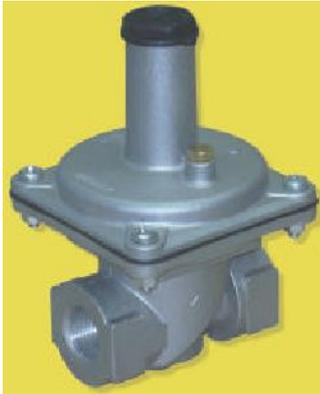
Корпус выполнен из алюминия. Внутренние части из алюминия, стали, латуни, синтетических материалов, уплотнения из нитрил-бутадиеновой основы (NBR). Пружина – нержавеющая сталь.
