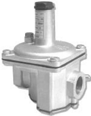
Стабилизаторы используются для установки в системах с автоматизированными горелками, смесительных, комбинированных и распределительных промышленных установках, а также везде, где необходимо точное поддержание давления непосредственно перед газоиспользующим оборудованием. Регуляторы работают без вспомогательной энергии, посредством пружины. Все модели снабжены 2 штуцерами (на входе и выходе) для замера давления.
