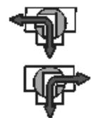
1. **Перебрасывающий L-образный (DEV)**, для переключения потока с центрального направления на второстепенное и наоборот. Шаровой кран приводится в действие однонаправленным шаговым сервоприводом, имеющим те же свойства, что и при 2-ходовом исполнении, и управляется термостатом. Вспомогательный выключатель может остановить циркуляционный насос во время закрытия последнего крана. С байонетным сопряжением возможен выбор позиции открытия крана, указанной на управляющем стержне.
