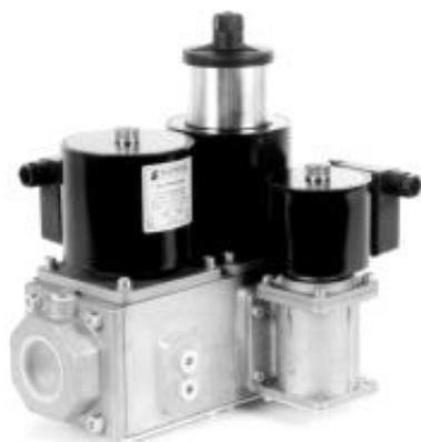
Первый клапан быстро открывающегося типа – предохранительный. Второй клапан – может быть как быстро открывающимся, так и медленно открывающимся, служит для регулирования расхода газа, с начальным участком быстрого регулирования и вторым участком медленного регулирования. Существует возможность параллельного подключения к нему третьего обводного клапана, выполняющего роль разводки или позволяющего получить второй быстрый (медленный) участок или два участка.
