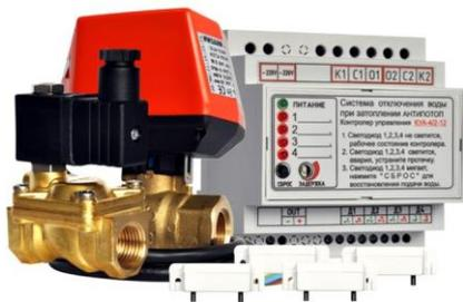
Система АНТИПОТОП – это надежная защита от затопления Вашего имущества, при аварии систем водоснабжения и отопления в квартире или доме. Составляющие системы АНТИПОТОП это – контролер управления, датчик затопления и исполнительные устройства, отключающие подачу воды при протечке.
