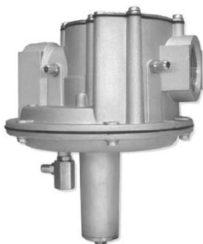
Регуляторы соотношения давления VRGA поддерживают очень точно и в широком диапазоне нагрузки давление газа перед горелкой в соответствии с давлением воздуха, то есть поток газа полностью зависит от механизма, регулирующего поток воздуха. Любые вариации с потоком, связанные с работой горелки, производят один и тот же эффект и на газ, и на воздух – соотношение всегда остаётся постоянным.
