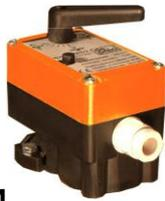
После установки смешивающий кран может быть моторизован посредством установки на него сервомотора – двунаправленного шагового с трёхпроводным управлением (откр-закр-нейтр), питание 220 / 24 В пер., или с пропорциональным управлением, питание 24 В пер. Время открытия/закрытия 130 с для M7M, 180 с для M8M, ход 90°
