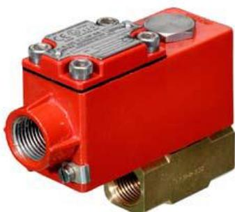
Предельно-допустимые значения минимального и максимального перепадов давления вход-выход, при которых клапан полностью закрывается/открывается, зависят от модели и указаны в инструкциях. **Для работы клапанов прямого действия и 108 типа минимальный перепад давления не требуется.**
