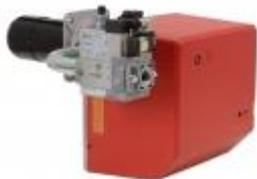
Диапазон мощностей от 11 кВт до 11,6 МВт. При одноступенчатом режиме регулирования могут работать горелки с максимальной мощностью до 522, от 58 кВт до 2,9 МВт – при двухступенчатом, от 93 кВт до 11,6 МВт – при прогрессивном/модулирующем. Для перехода от прогрессивной к модулирующей горелке необходимо дополнительно приобрести модуляционный комплект с датчиком температуры или давления.
