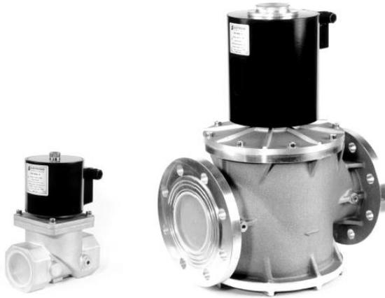
Клапаны типа VMR / VML производства Elettromeccanica Delta (Италия) являются электромагнитными одноступенчатыми клапанами быстрого / медленного открытия, закрытыми в нормальном состоянии. Они используются для автоматической подачи или перекрытия газа, воздуха в газовых горелках, атмосферных газовых котлах, печах, другом газоиспользующем оборудовании.
